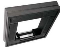
Tipo quadro di alta precisione, con lato magnetico verticale a 90° a piano liscio e tre lati prismatici, finemente rettificati. Con 2 bolle. Tipo di alta precisione DIN 877. In ghisa stabilizzata. Impugnatura termoisolante. Grazie a un accurato montaggio, le bolle garantiscono una particolare e costante precisione di misurazione. Vetro di protezione per la bolla longitudinale. In astuccio.
